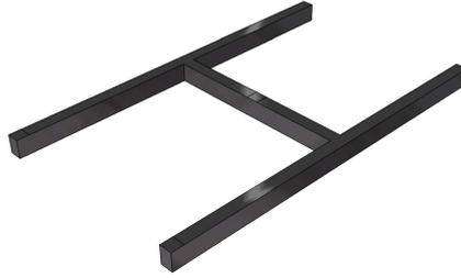
Figure 1: Sistema di ancoraggio e livellamento del detector XENON 010
