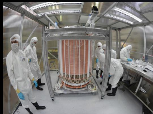
La camera a proiezione temporale (TPC) durante la fase di montaggio (sinistra); Rappresentazione 3D della TPC (destra).
